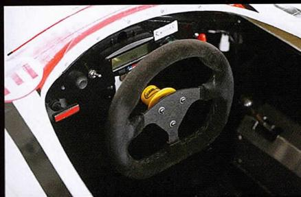
クイックリリース付きのステアリングはシンプルそのもの。スイッチも何も備わらず運転に集中できる。転舵時はそれなりに重さがあるが、フロントタイヤが溝付きで細いので、めぐるような重さではない。メーターはデジタルで小型。シフトタイミングは赤いランプが点灯するインジケーターを見るといい。
